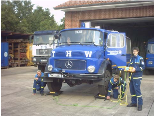
Titel: Junghelfer beim Anheben eines LKW mit Hebekissen
